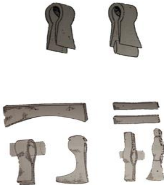
Рис. А. 31. Технологічні схеми і етапи виготовлення сокири і чекана [Бережинський 2000, С.199-200]
