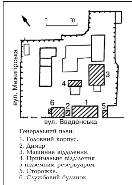
434. Подільська машинна станція міської каналізації.
