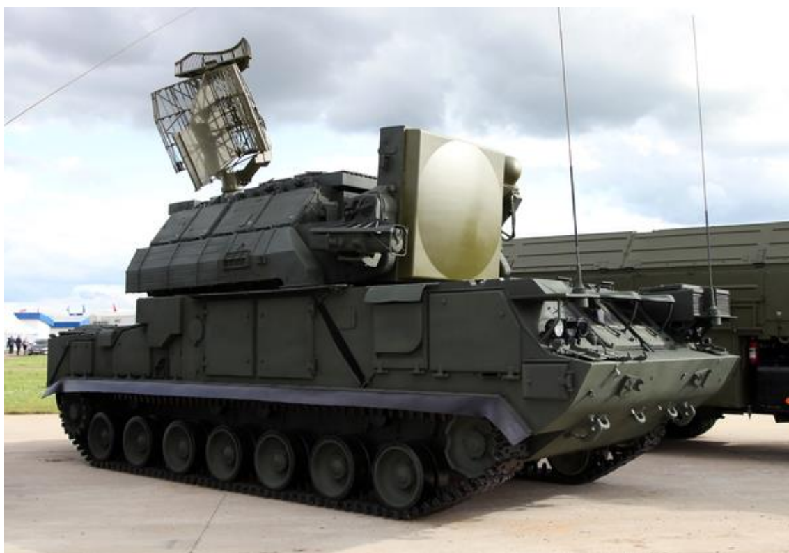
Рис. 4.5 – Елементи ЗРС “Тор-М1” (бойова машина 9А331)
