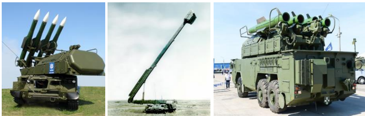
Рис. 4.6 – Елементи ЗРК “Бук-М2” (самохідна вогнева установка, радіолокатор підсвіту та наведення та самохідна вогнева установка на колісному шасі МЗКТ-6922)
