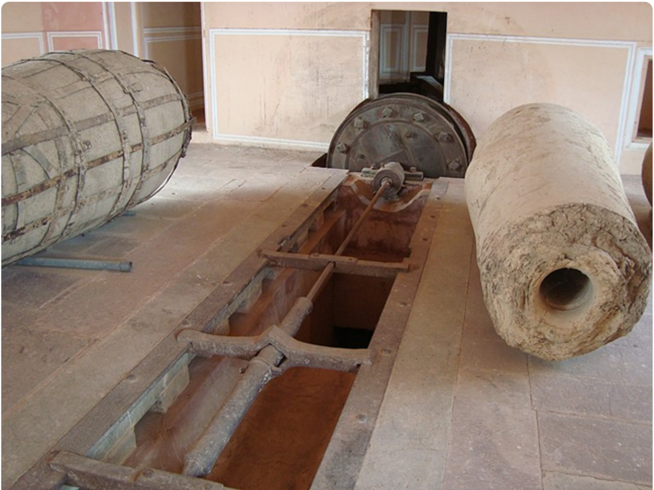
Гарматний свердлильний цех. Зверніть увагу на товщину стінок гарматного кожуха - праворуч. Ліворуч гарматний кожух укріплений металевими стрічками.
