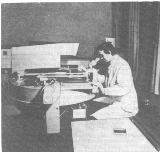
Мал. 8. Вимірювальна машина «Аскорекорд» для визначення координат світил на фотопластинці (Головна астрономічна обсерваторія АН УРСР у Києві)
