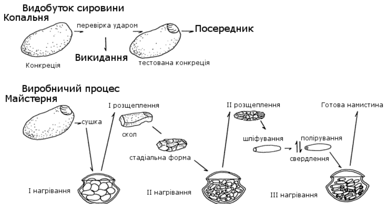
Рис. Ж.5. Операційний ланцюжок обробки агатової намистини. Камбат, Індія. За Kenoyer et al. 1991.
