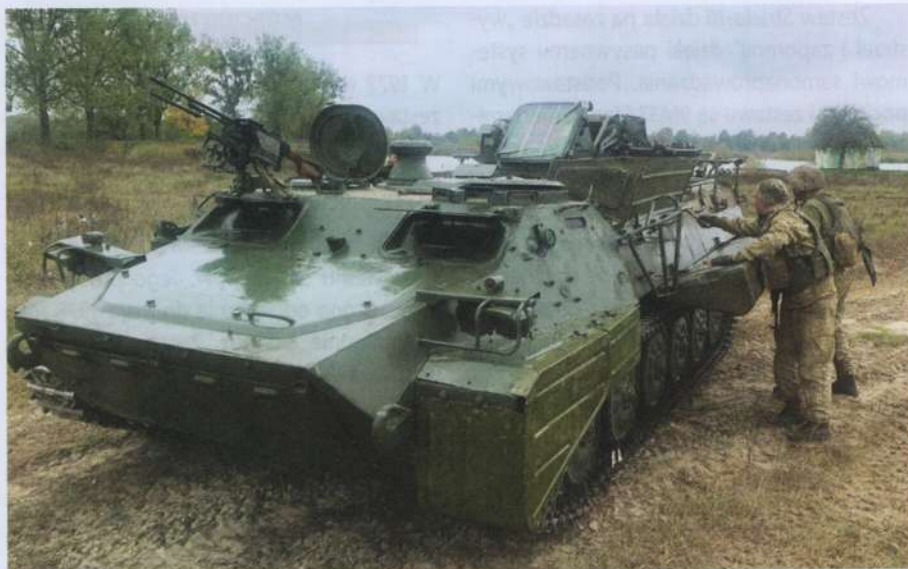
▲ Striela-10M2 z 28. SBZmech podczas konkursu najlepszy raketowy pluton przeciwlotniczy (październik 2020 roku). W położeniu marszowym wyrzutnia pojazdu Striela-10 składa się do tyłu.
