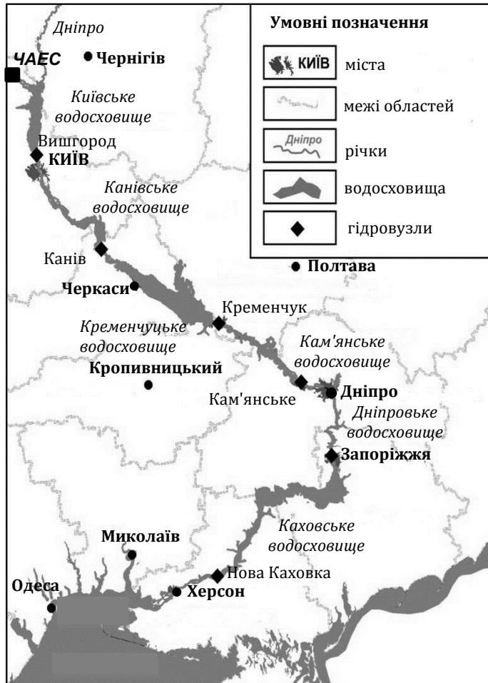
Рис. 1.5. Каскад водосховищ на р. Дніпро (Київське, Канівське, Кременчуцьке, Кам'янське, Дніпровське, Каховське) і розташування Чорнобильської АЕС (ЧАЕС)
