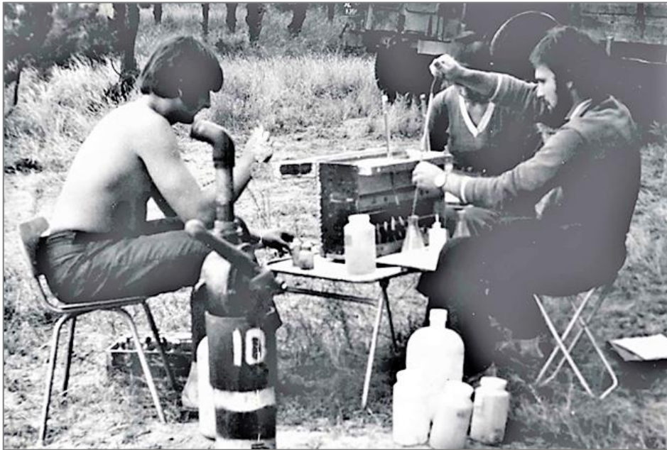
Ф.7. Дослідження проб води на березі озера Світязь за допомогою польової гідрохімічної лабораторії для аналізу води (ПЛАВ). Експедиція Київського державного університету ім. Т.Г. Шевченка. Шацькі озера, Волинь. 1975 р.
