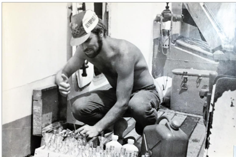
Ф.6. Визначення вмісту кисню у воді методом Вінклера під час експедиції на науково-дослідному судні. 1974 р.
