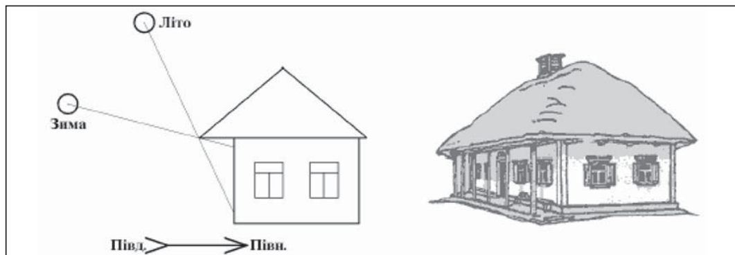
Рис.2. Застосування піддашків, характерних для українського будівництва минулих століть, як компонентів енергозбереження одноповерхових приватних будинків. Ліворуч: схема будинку з піддашком вздовж довгої частини будинку, орієнтованої на південь. Праворуч (рис. взято з [5]): хата в Новосанжарському районі Полтавської області
