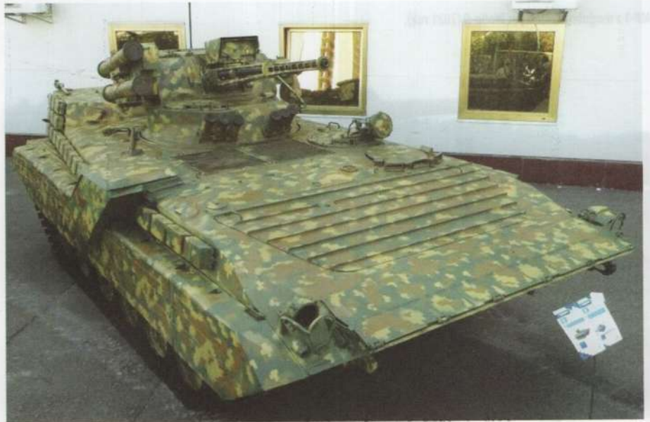
▲ BMP-1UM z modułem bojowym Szkwał-A . Na prawej burcie zamontowano rozpraszacz gazów wylotowych, obniżający cieplną sygnaturę pojazdu (2015 rok).
