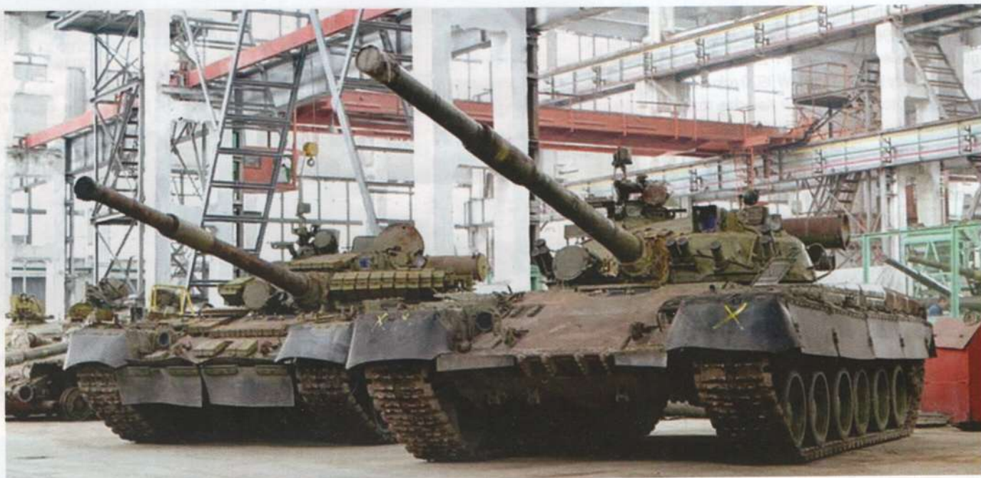
▲ T-80B w hali Charkowskich Zakładów Naprawy Czołgów. Podczas remontu czołg zmodernizowano do standardu T-80BW.
