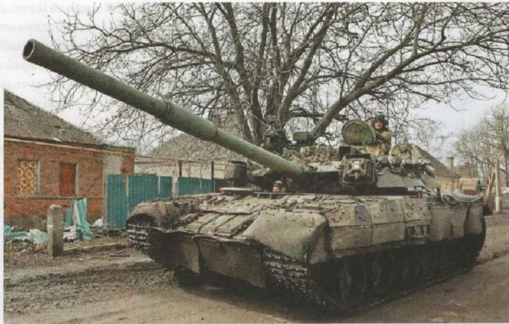
▲ Zdobyczny T-80U, na którym zamontowano optyczno-elektryczny system przeciwdziałania Sztora-1 (2023 rok).
