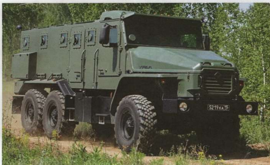
▼ Pojazd Urał-WW ma klasyczny układ z maską silnika przed kabiną.
