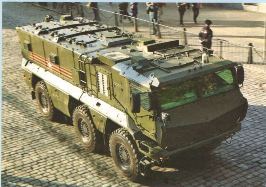
▲ Pojazd opancerzony Tajfun-K odznacza się dość dużymi wymiarami. Na zdjęciu widoczna konstrukcja stropu kadłuba, w tym sześć włazów nad przedziałem desantu.
