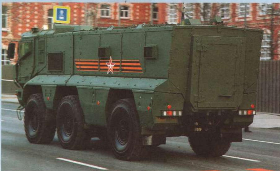
▲ Dostęp do przedziału użytkowego Tajfun-K umożliwiają tylne drzwi. W kadłubie brak strzelnic, nie ma również na wozach seryjnych uzbrojenia stałego, choćby i karabinów maszynowych na obrotnicach.
