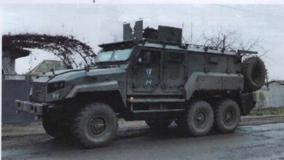
▲ Opracowany w ekspresowym tempie i równie szybko dostarczony do jednostek rosyjskich samochód opancerzony Z-ST5 Achmat.
