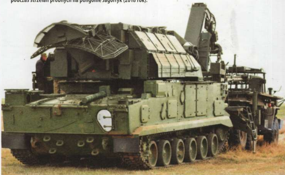
▼ Wóz bojowy 9A330 oraz transportowo-załadawczy 9T231 podczas strzelań próbnych na poligonie Jagorłyk (2018 rok).
