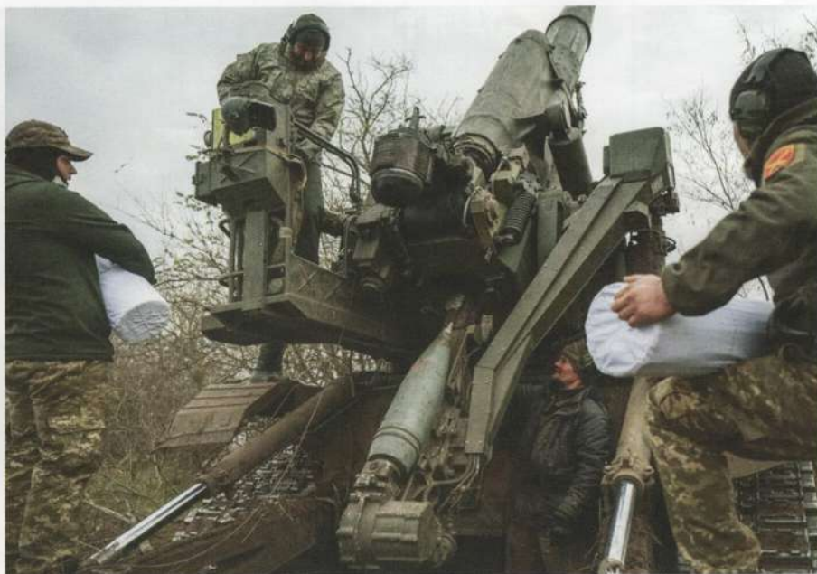
▲ Załadunek pocisku do ukraińskiej armaty 2S7. W ukraińskiej armii odczuwalny jest brak amunicji kal. 203 mm, z kolei Rosjanie zwracają uwagę, że Pion/Malka nie posiada pocisków precyzyjnych (korygowanych).
