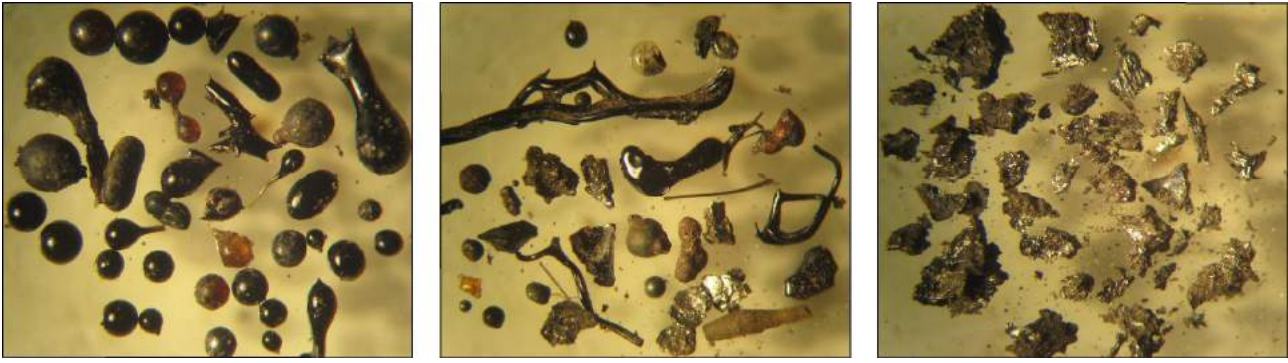
Рис. 42. Уламки шлаків і зольних сферичних утворень із сучасних ґрунтів і відкладів м. Маріуполь (збільшення 10)
