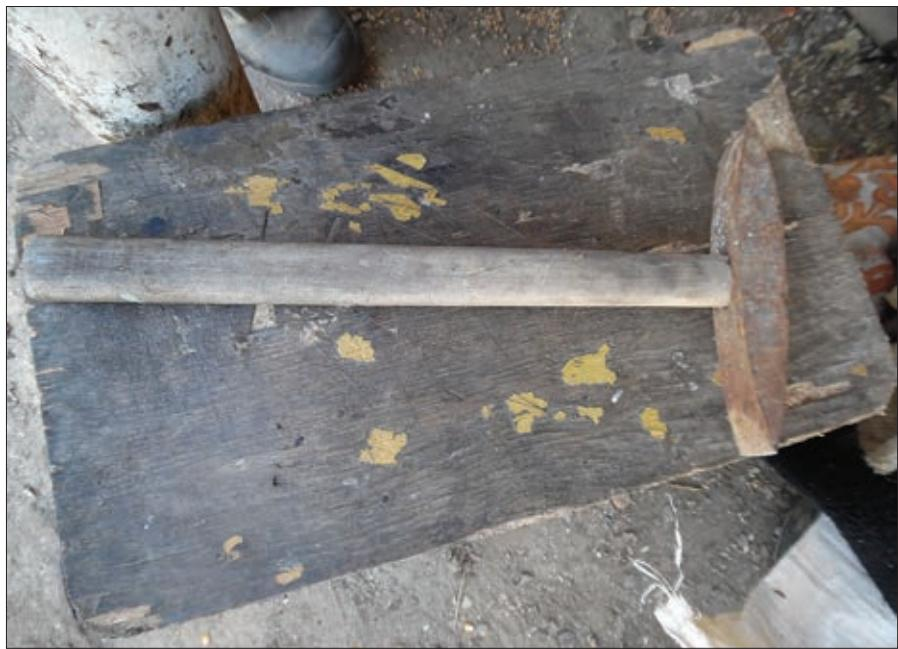
**Рис. 12.** Оскард — спеціальний інструмент для насічування робочої поверхні ручних жорен (с. Нижнє Деражнянського району Хмельницької обл.). Фото В. Іванчишена. 2015
