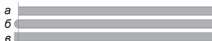
Мал. 3.9.14. Закінчення лінії а) прямокутне закінчення б) закруглене закінчення в) витягнутий квадрат
