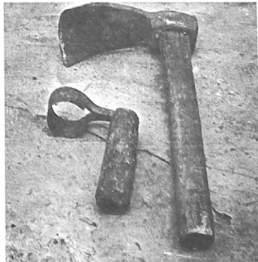
"Кельня" і "шklubка" для виготовлення човна-однодеревки (с. Макалевичі). Світлина автора
