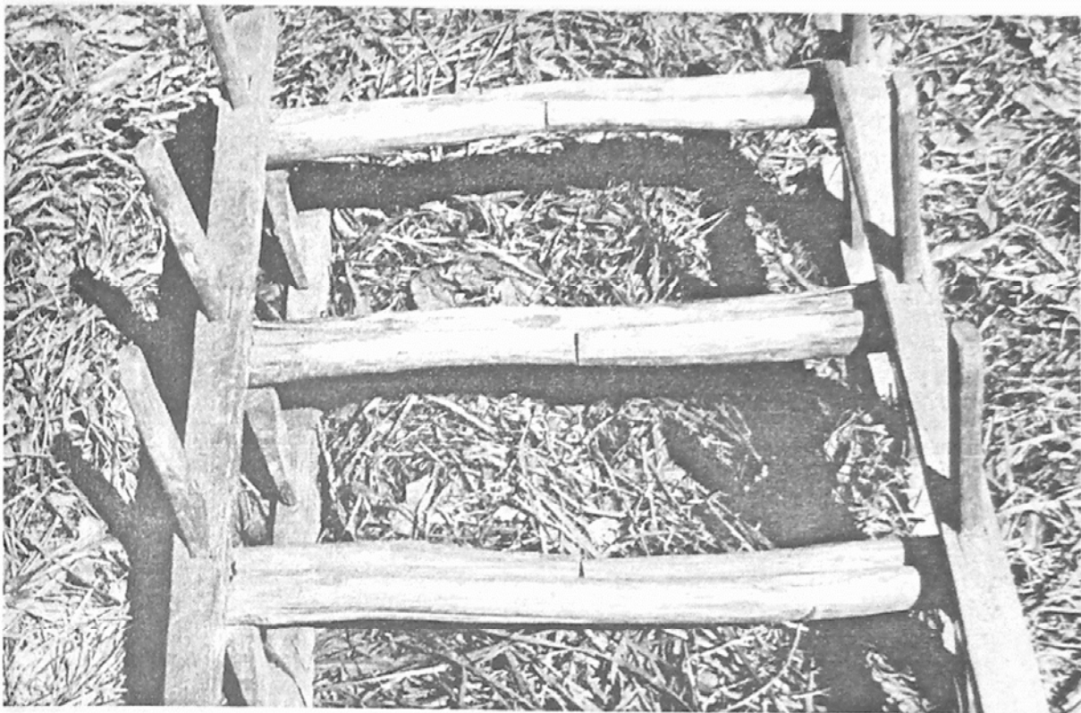
8. В'язова система з'єднання полозів (с. Листвин). Фото автора
