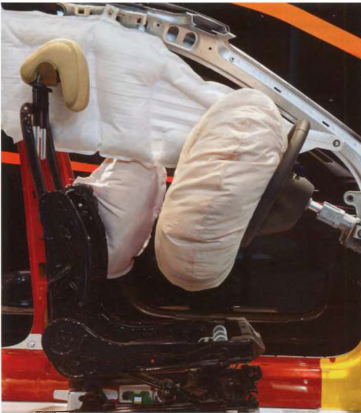
Рис. 1-6 Бічні подушки безпеки та повітряні завіси можуть становити небезпеку для рятувальників, якщо пристрої не спрацювали під час зіткнення. Примітка. Додаткову інформацію про забезпечення безпеки нерозгорнутих подушок безпеки дивіться у Access: First on Scene – Rapid Vehicle Entry Provider Manual від IFLS. (Фото з Shutterstock)
