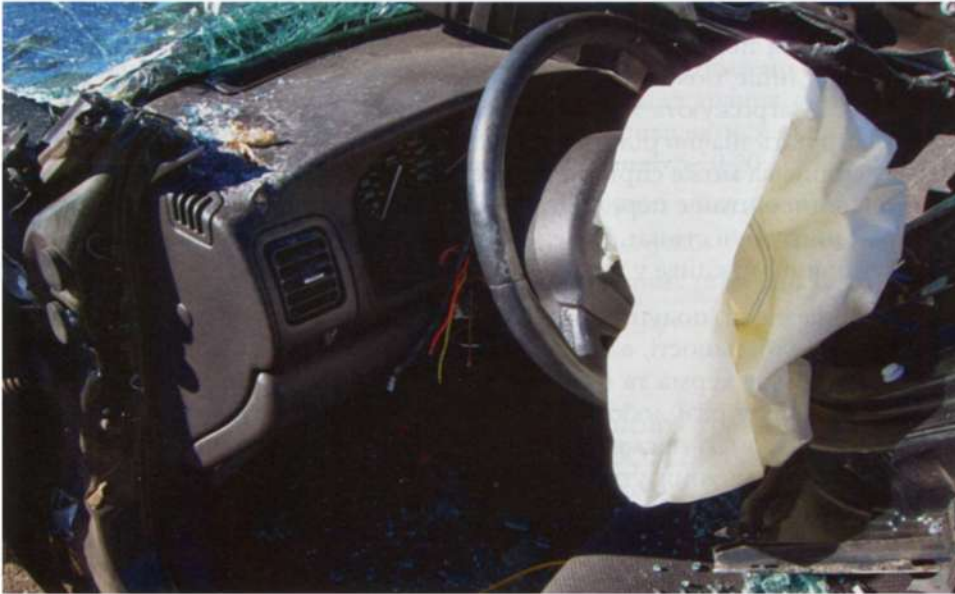
Рис. 1-3 Підніміть подушку безпеки, яка згорнулася, щоб виявити, чи є деформація керма. (Фото надано Olivier Le Queinec / Shutterstock)
