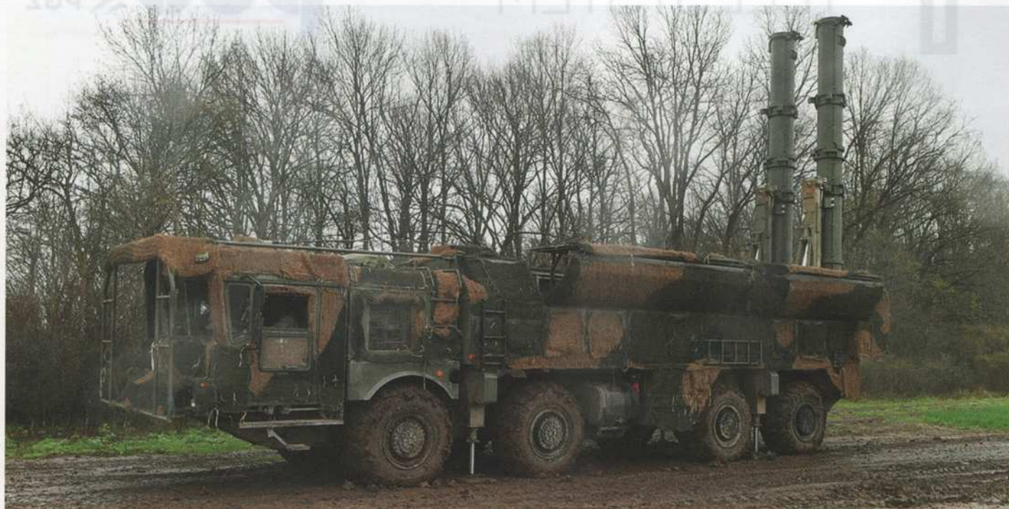
Rozwinięcie bojowe wyrzutni systemu raketowego Iskander-M (z dwoma pociskami manewrującymi 9M728/R-500) na kierunku charkowskim w połowie kwietnia. Zwraca uwagę siatka maskująca. Według źródeł ukraińskich w rejonie Charkowa operowało w kwietniu/maju nawet do pięciu dywizjonów systemu Iskander .
