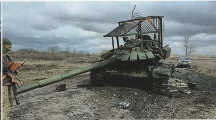
Zniszczony T-72B3 (obr. 2016), na wieży zupełnie nieefektywna klatka prętowa przeciwko minbombom zrzucałym przez bezzałogowce i ppk atakującym z górnej półsfery.
