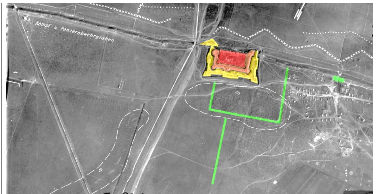
Рис. 4. 9. Структура укріплення фортеці Перекоп. Замково-полігональна система. (Опрацьовано автором, джерело фотографії: Архів ВВС ІІ СВ.)
