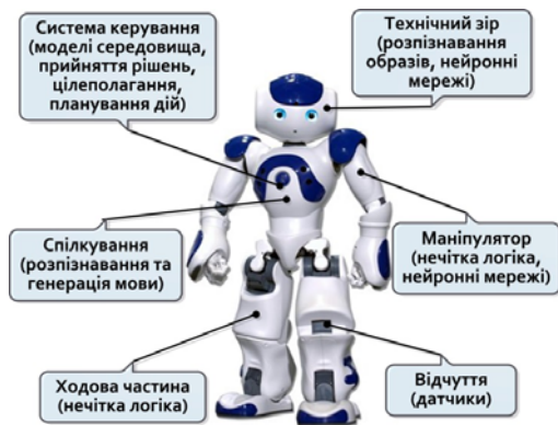
Рис. 5.2. Методи штучного інтелекту в системі керування робота
