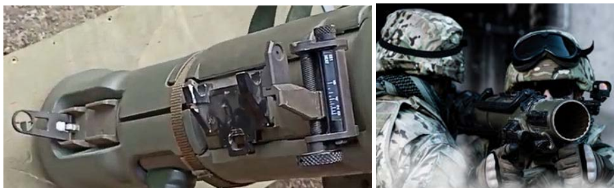
Малюнок 4.2.19 – Механічний приціл з мушкою; справа – прицілювання в Grg
