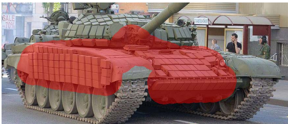
Малюнок 3.1.34 – Вразливі зони танків Т-72БВ, від гранат тандемної дії ПГ-7ВР при обстрілу спереду
