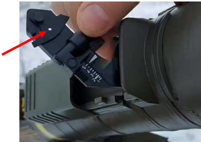
Малюнок 3.5.6 – Приціл в бойовому положенні. Стрілкою позначено діоптр
