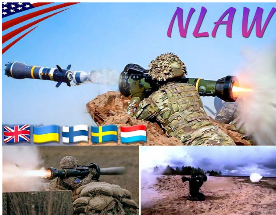
Малюнок 6.7.14 – Двигун ракети запускається на безпечній від стрілка відстані
