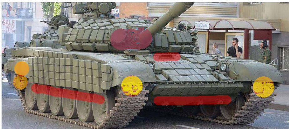
Малюнок 3.1.33 – Вразливі зони Т-72БВ, Т-80БВ при фронтальному обстрілі
