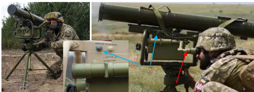
Малюнок 6.4.7 – Позиція для стрільби. Червона стрілка – окуляр прицілу; Синя стрілка – кнопка активізації комплексу
