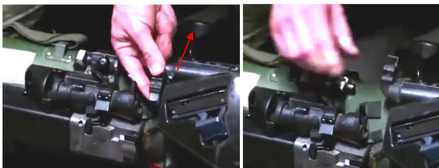
Малюнок 6.7.8 – Встановлення механічного прицілу, стрілка – напрям руху
