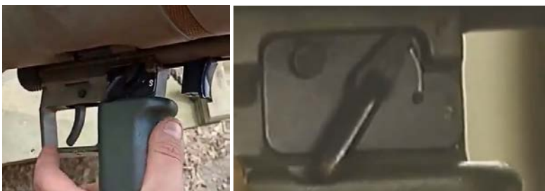
Малюнок 4.2.18 – Запобіжник на «F» – відкриття вогню
