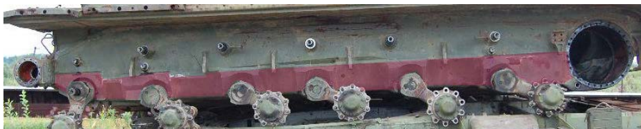
Малюнок 5.1.14 – Танки серії Т-80У мають, як видно на фото, аналогічну ослаблену, тільки вже 35-ти мм ділянку з розвалом 10^{\circ} (виділено червоним), вразливу для АВГ та для РПГ
