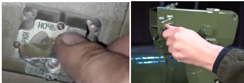
Малюнок 6.1.5 – Три режими стрільби (зліва) та увімкнення світлофільтру
