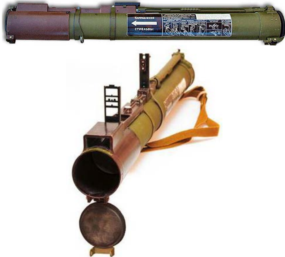
Малюнок 3.3.1. РПГ-22. Зверху – загальний вигляд, знизу – у бойовій готовності.
