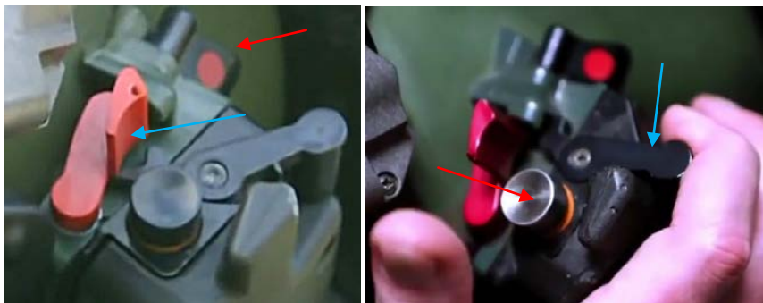
Малюнок 6.7.12 (зліва) – Червона стрілка: запобіжник; Синя стрілка: захисна скоба. Малюнок 6.7.13 (справа) – Синя стрілка – утримання контролеру; Червона стрілка – кнопка «пуск»
