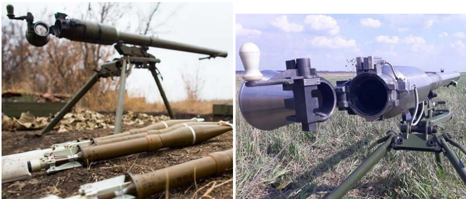
Малюнок 4.1.4 – СПГ-9 «Коп'є» (зліва) та СПГ-9АМ «Ланця» (справа) з відкритим затвором та підготовленими пострілами
