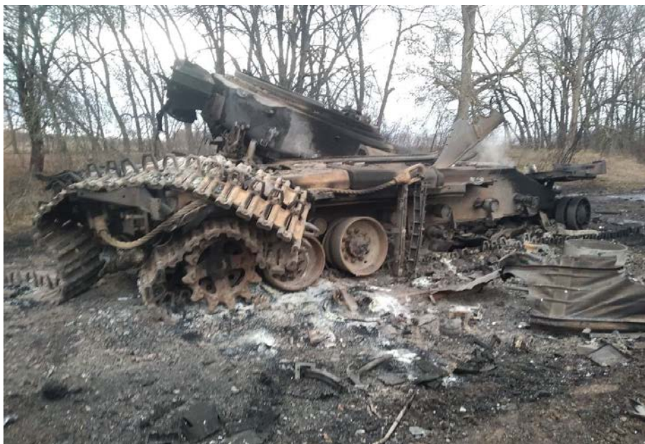
Малюнок 6.6.18 – Знищений Збройними Силами України російський танк Т-80УМ за допомогою ПТРК «Javelin» під Сумами. Вибух БК та зрив бащити
