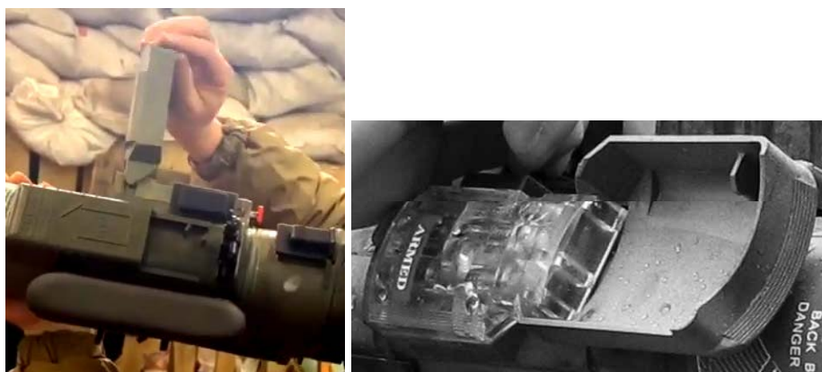
Малюнок 3.6.8 – Розгортання запобіжної кришки механізму стрільби
