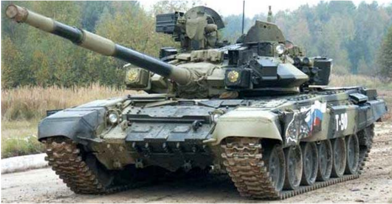
Малюнок 1.4.1 – Т-90. Праворуч та ліворуч від гармати два «ящикоподібних» блока комплексу «Штора-1». Комплекс вимкнено
