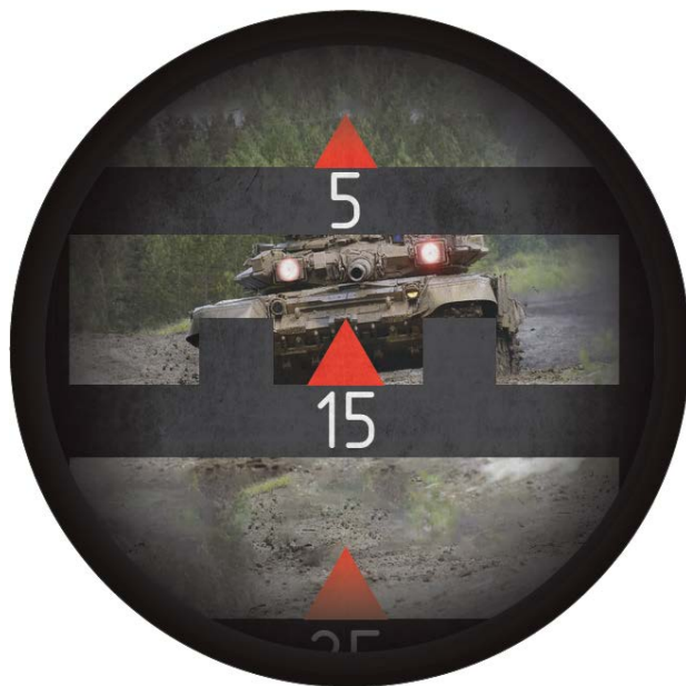
Малюнок 3.3.2 – Видимість у приціл РПГ-22. Відстань до танка Т-90 складає 150 м
