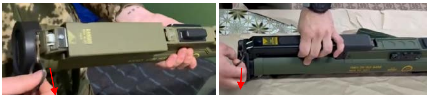
Малюнок 3.12.3 – Висмикування чеки А6 (зліва) та ЕС Mk.I (справа), стрілки – напрям руху
