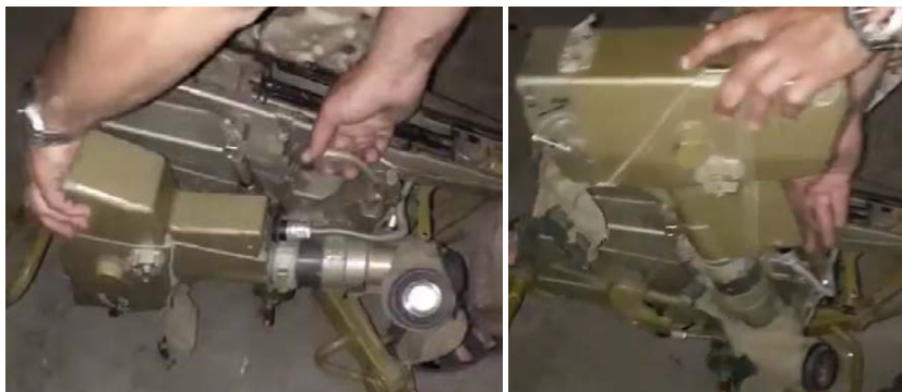
Малюнок 6.1.4 – Підняття прицілу у бойове положення
