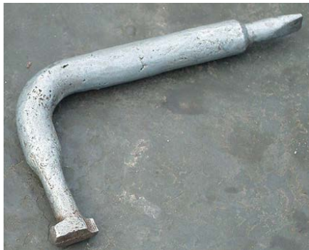
Малюнок 2.1.7– «Ключ від танка» або як його ще називають – баштовий ключ
