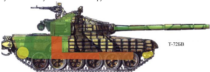
Малюнок 3.1.31 – Вразливі зони Т-72БВ, Т-72БА, Т-80БВ при обстрілі в борт
