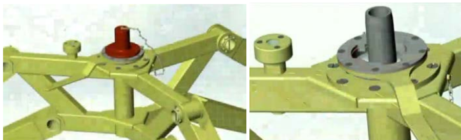
Малюнок 6.5.2 – Зліва: заглушка в центрі триноги; Справа: заглушка знята
