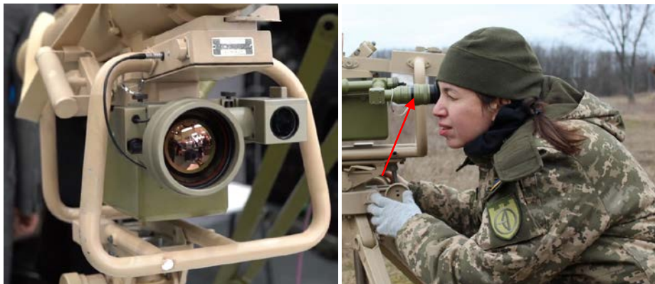
Малюнок 6.4.4 – Лазерний та оптичний канали; Стрілка – окуляр прицілу
