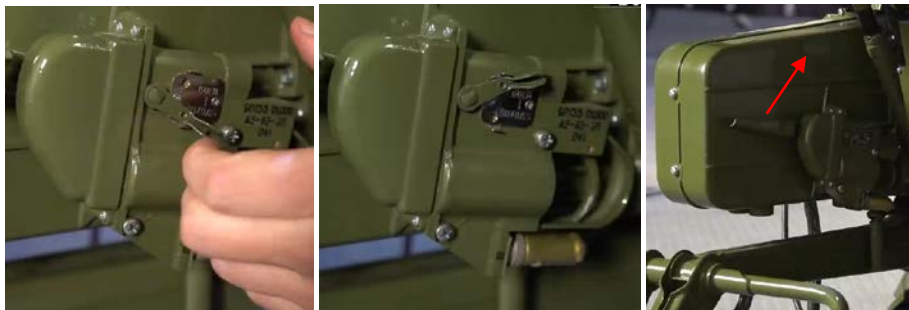
Малюнок 6.1.8 – Зліва направо: Запобіжник в похідному положенні; Запобіжник в бойовому положенні; Зведення пускового механізму, стрілка – напрям руху
