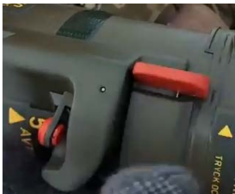
Малюнок 3.5.8 – Зліва – запобіжник віджатий вгору; Справа – Розташування кнопки «спуск» за запобіжником на РПГ. Жовтими стрілками показано напрямлення руху натискання
