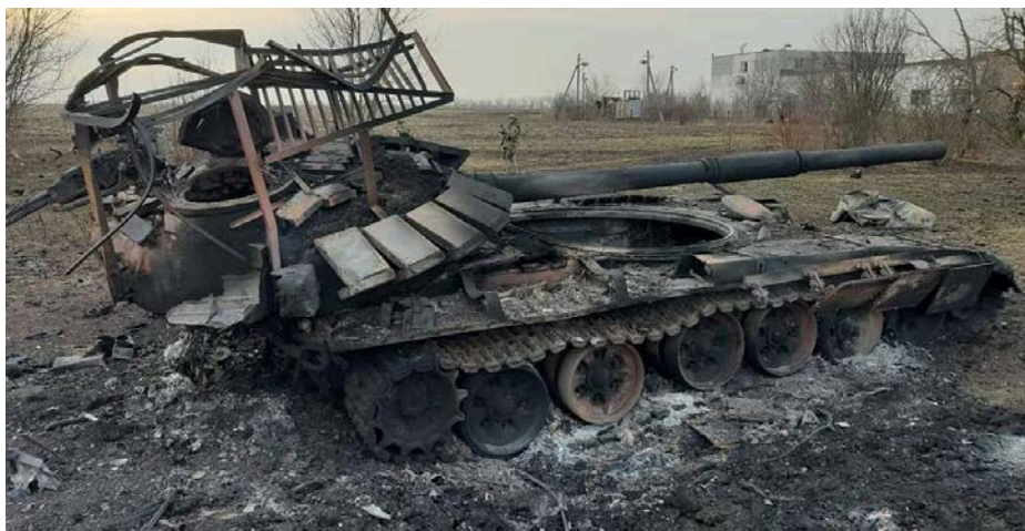
Малюнок 6.6.17 – Т-72Б3 росії з додатковою «протиджавеліною» решіткою на бащиті, знищений Штурмовиками 128-ї окремої гірничо-штурмової Закарпатської бригади 30.03.2022 р. Після враження ракетою у танку здетонував БК, внаслідок чого його бащиту зірвало. Екіпаж знищено без можливості ідентифікації. Верхня решітка від ПТРК «Javelin» не захистила
