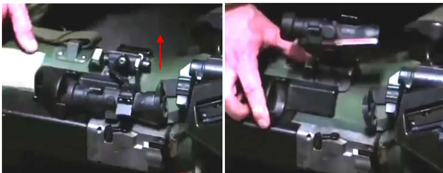
Малюнок 6.7.7 – Встановлення оптичного прицілу, стрілка – напрям руху
