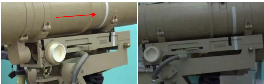
Малюнок 6.5.9 – Встановлення та фіксація ракети, стрілка – напрям руху
