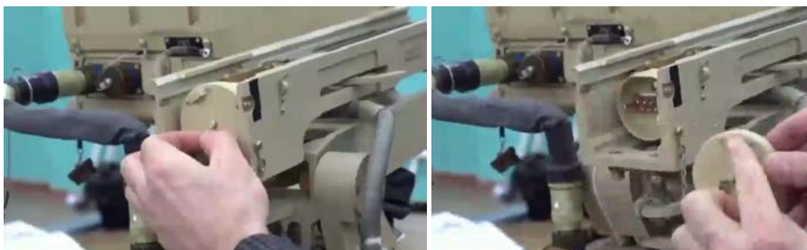
Малюнок 6.5.8 – Заглушка встановлена (зліва) та знята (справа)
