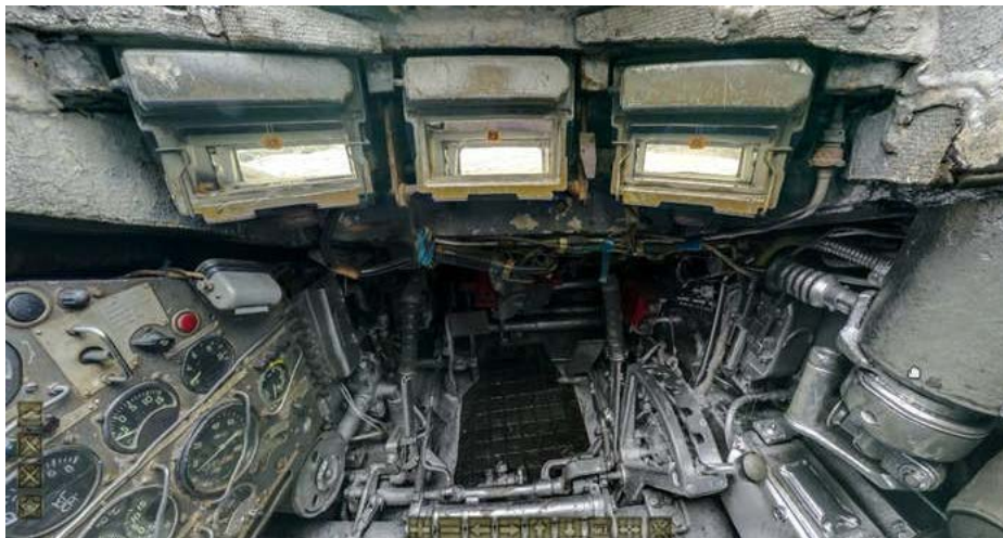
Малюнок 1.6.4 – Місце механіка-водія Т-80УМ та Т-80УК. З фото видно, що завдяки 3-м триплексам проти одного в Т-72/Т-90, водій Т-80 має набагато кращу видимість, ніж зазначені танки УВЗ
