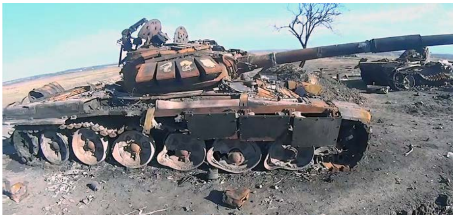
Малюнок 1.2.3 – Т-72БА1 – стався вибух боскомплекту, башту не зірвало, через те, що мабуть снарядів було мало, але полопалися торсіони і танк впав на черево. Далі справа стоїть ще один такий же, але з зірваною баштою
