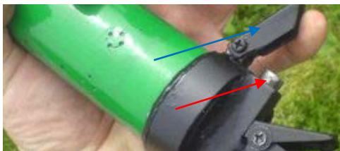
Малюнок 3.8.6 – Синя стрілка – запобіжник; червона стрілка – кнопка пострілу
