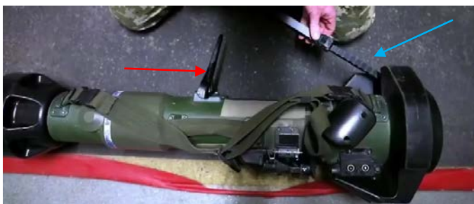
Малюнок 6.7.10 – Червона стрілка: плічковий упор; Синя стрілка: поясний упор
