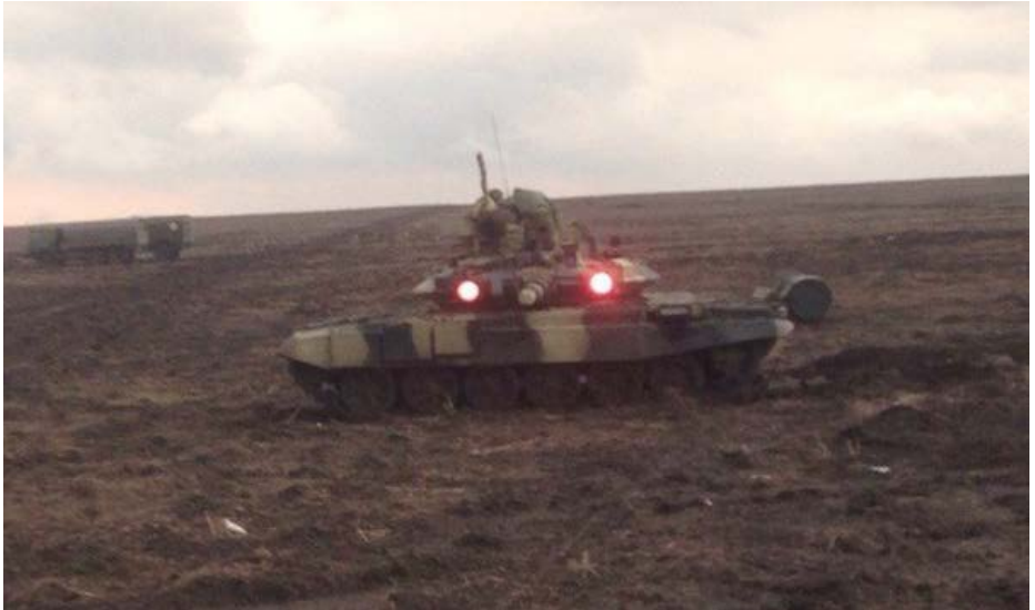
Малюнок 1.5.1 – Т-90А. Комплекс «Штора» включений і через нього танк дуже добре себе демаскує навіть вдень
