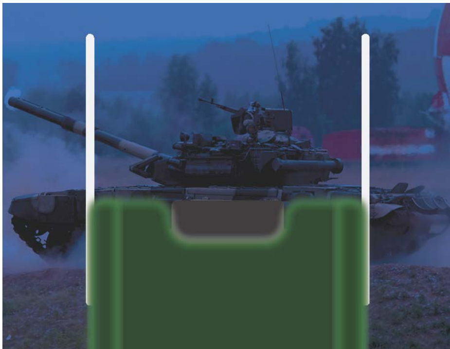
Малюнок 3.3.4 – Видимість вночі через нічний приціл РПГ-22, відстань до танка Т-90А складає 100 м. Вертикальні білі лінії – кріплення стойки діоптра
