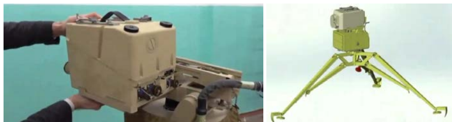
Малюнок 6.5.4 – Встановлення приладу наведення ПН-І на платформу
