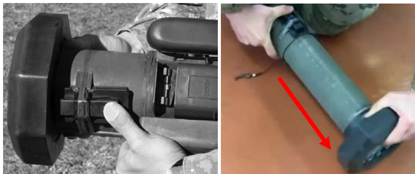
Малюнок 3.6.3 – Витягування внутрішньої труби, стрілка – напрям руху
