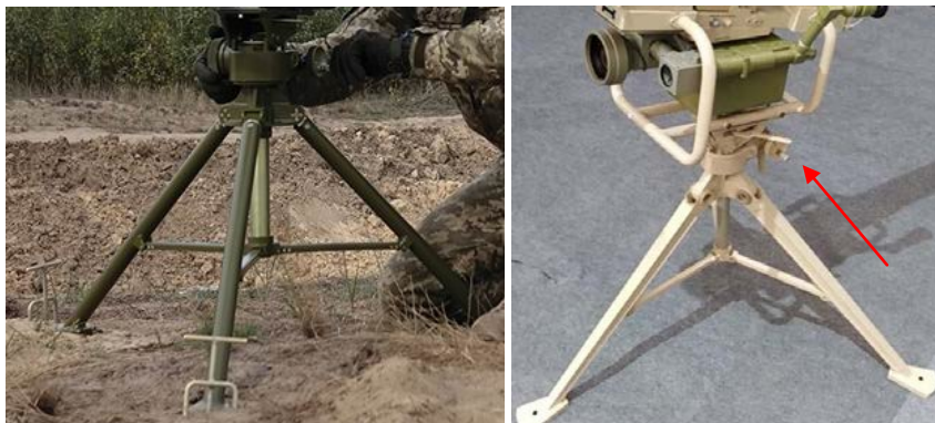
Малюнок 6.4.2 – Встановлення триноги та пускової. Червона стрілка – ричаг кріплення
