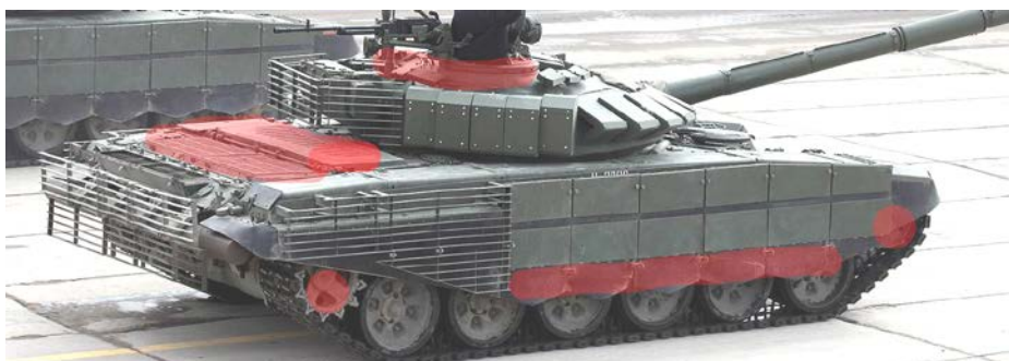
Малюнок 3.1.38 – Ураження Т-72Б3М та Т-80БВМ від гранат нетандемної дії, збоку та ззаду. Тандемна граната ПГ-7ВР пробиває танки в будь-яку крапку.
