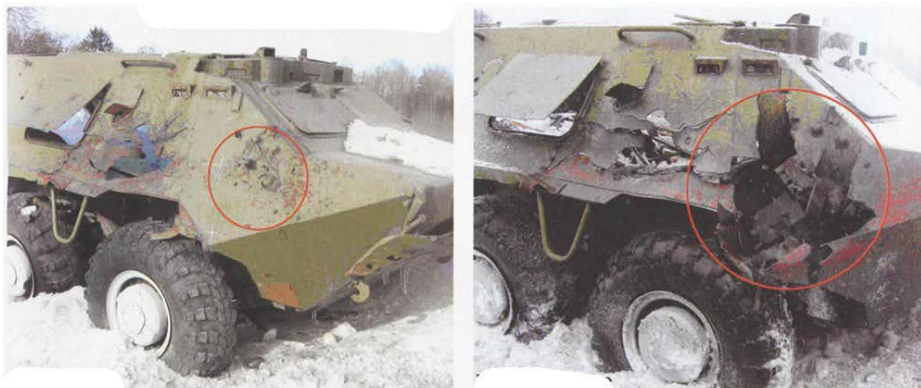
Малюнок 3.1.41 – Червоними колами позначено: зліва – дія кумулятивної гранати по БТР; справа – дія ТБГ-7В по БТР
