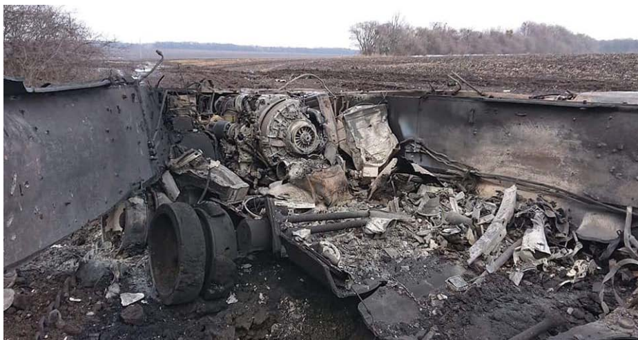
Малюнок 6.7.2 – Танк Т-80ВВ армії РФ, знищений Холодноярівською піхотою ЗС України за допомогою ПТРК «NLAW», ніяка ДЗ не допомогла – детонація БК, зрив бапти, розрив корпусу вицент.
