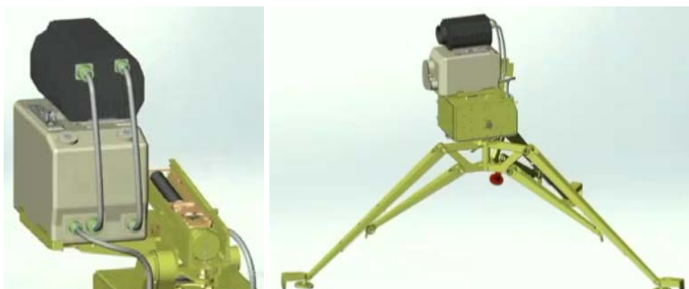
Малюнок 6.5.6 – Кріплення ТПВ та його кабелів
