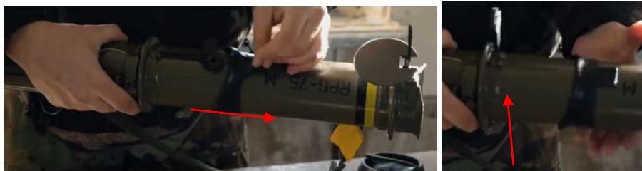
Малюнок 3.9.3 – Висвободження прицільної планки
