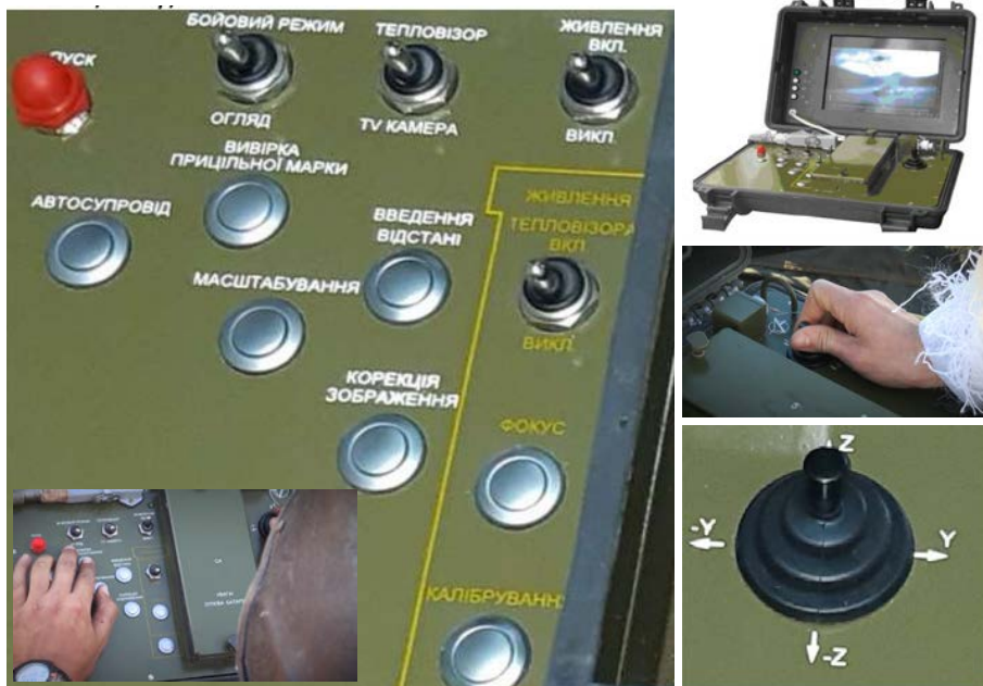
Малюнок 6.5.10 – Органи управління пульта керування, справа – джойстик точного наведення ракети на ціль
