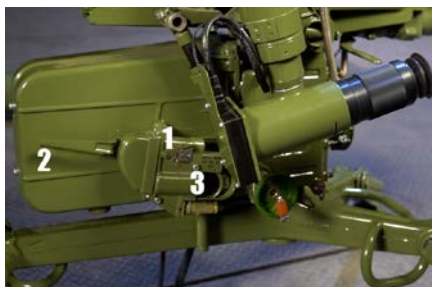
Малюнок 6.1.12 – Зліва: пуск ракети з перевищенням, червона крапка біля перехрестя – видимий в оптику трасер ракети; Справа: 1-запобіжник, 2-рукоятка зведення, 3-спусковий гачок
