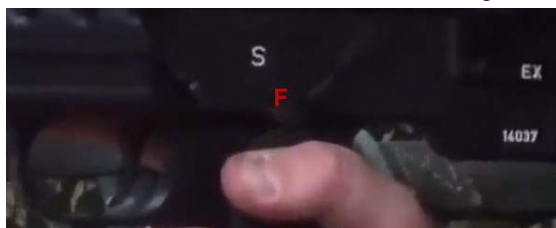
Малюнок 3.7.6 – Приведення гранати з фугасного в протитанкове положення, червоною стрілкою показано напрям руху
