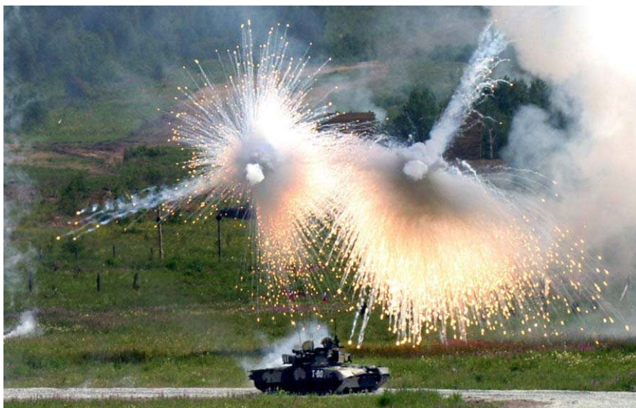
Малюнок 1.6.3 – Т-80УК. На фото показана робота КОЕП «Штора-1»
