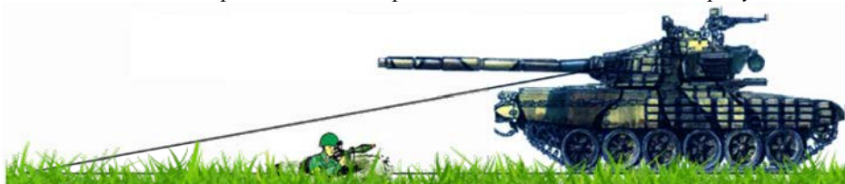
Малюнок 2.1.2 – Мертва зона для зброї танка Т-72, Т-80, Т-90 ззаду – 37 м
