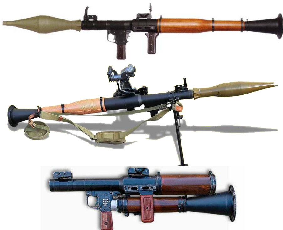
Малюнок 3.1.1. Зверху донизу: РПГ-7 з гранатою ПГ-7ВМ; РПГ-7В з гранатою ПГ-7ВС, «оптикою» та сошками; РПГ-7Д в складеному вигляді
