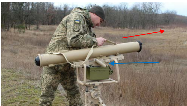
Малюнок 6.4.5 – Встановлення ракети. Червона стрілка – напрям руху при з'єднанні; Синя стрілка – ручка пуску
