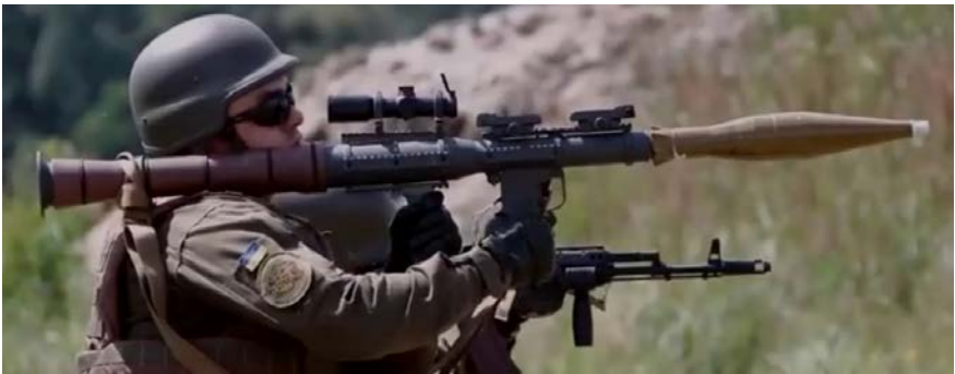
Малюнок 3.1.3 – РПГ-7, виробництва США, що поставляється в Україну має сучасні вдосконалення у вигляді планок Пікатінні для кріплення оптики, та назву «PSRL-1»
