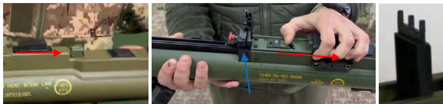
Малюнок 3.12.5 – Переміщення запобіжника – червоні стрілки і напрям руху А6 (зліва) та ЕС Mk.I (в центрі); Приціл – синя стрілка; Мушка (справа)
