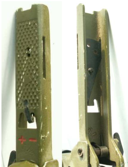
Малюнок 3.2.2 – Діоптр РПГ-18 вигляд спереду та ззаду
