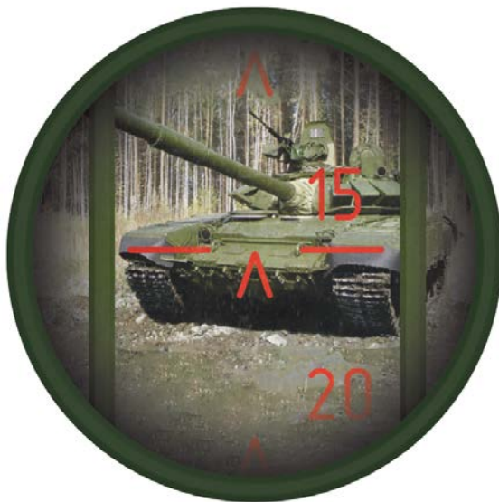
Малюнок 3.2.4 – Видимість в приціл РПГ-18 зразка 1972 року. Відстань до танка Т-72Б3 складає 150 м
