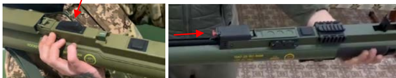
Малюнок 3.12.6 – Кнопка спуску А6 (зліва) та ЕС Mk.I (справа) – по стрілці
