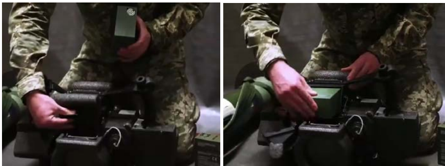
Малюнок 6.6.4 – Встановлення батареї живлення (вистачає на 2 пуски)
