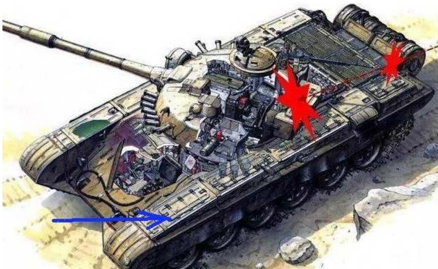
Малюнок 2.1.8 – Розріз танка Т-72/Т-90; Пошкодження його з РПГ Carl-Gustaf в корму (червоний колір) та розташування ящика ЗІП з ключем від танка (синій колір)
