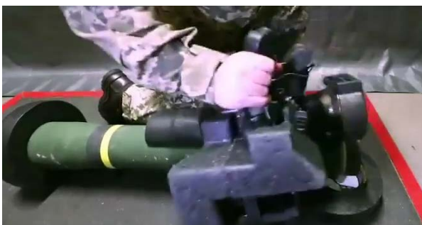
Малюнок 6.6.7 – З'єднання ракети з блоком управління
