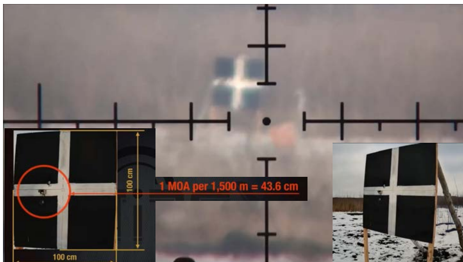
Малюнок 5.1.5 – Упередження взяті в приціл Snipex JOVE 50 в мішень розміром 1,0x1,0 м, з відстані 1500 метрів; На врізках – результати влучень
