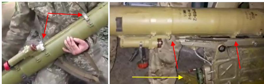
Малюнок 6.1.7 – Встановлення ракети на пускову установку. Червоні стрілки – кріпінж контейнеру ракети; Жовта стрілка – напрям руху ракети по положкам
