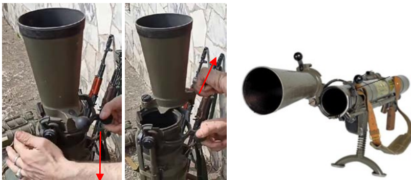
Малюнок 4.2.16 – Віджимання запірного пристрою (зліва) та відкриття затвору (по центру); стрілки – напрям руху
