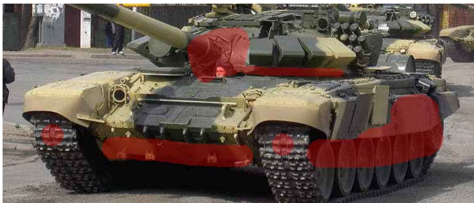
Малюнок 3.1.36 – Танки типу Т-72, Т-90, Т-80 з ДЗ Контакт-5, зони ураження для гранат не тандемної дії. Тандемна граната ПГ-7ВР пробиває корпус в будь-яку крапку. Ззаду танки не захищені
