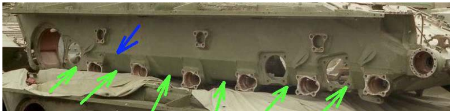
Малюнок 5.1.13 – Та ж 20-ти мм ділянка борту танків Т-72/Т-90 – показана зеленими стрілками, розташована нижче зварювального шва верхнього листа борту – позначена синьою стрілкою. Т-80БВ має таку ж саму 20-ти мм ділянку борта
