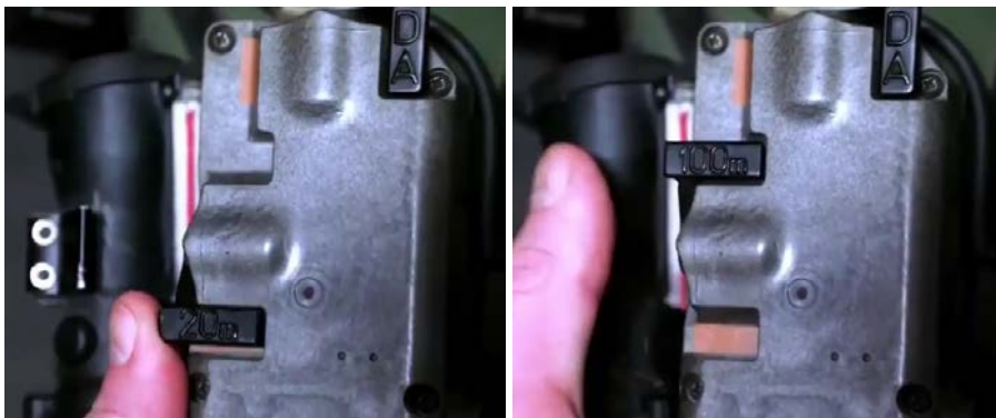
Малюнок 6.7.6 – Перемикання важеля відстані
