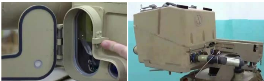
Малюнок 6.5.5 – Відкриття вікна приладу наведення ПН-І (зліва) та з'єднання кабелю живлення приладу наведення
