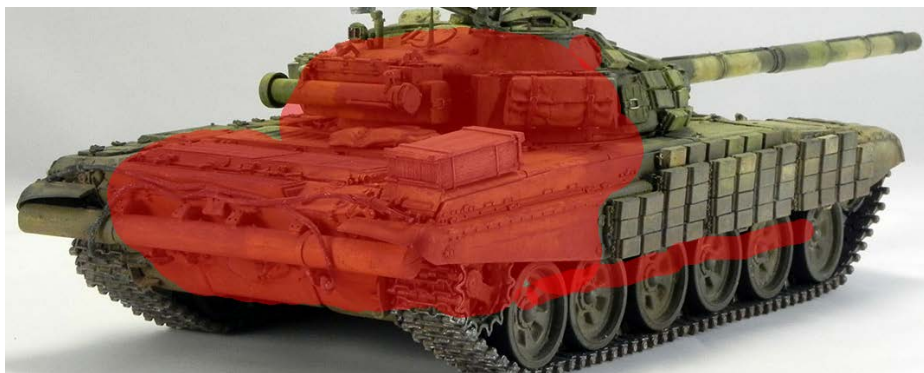
Малюнок 3.1.35 – вразливі зони танків Т-72БВ, Т-80БВ від гранат одинарної дії при обстрілі ззаду
