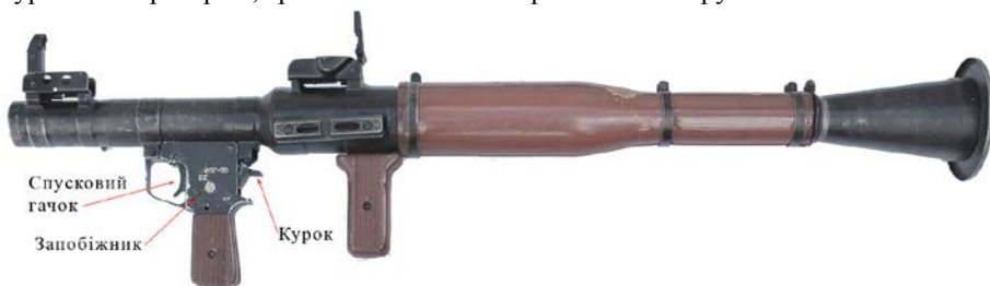
Малюнок 3.1.14 – Розташування запобіжника, курка та спускового гачка в РПГ-7 всіх модифікацій, в тому числі РПГ-М7 виробництва України
