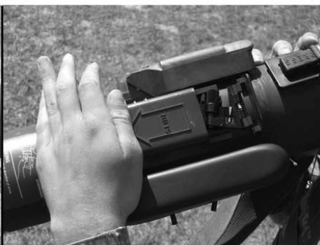
Малюнок 3.6.6 – Розкриття кришок цілика та мушки. Зліва – мушка, справа – цілик. Стрілками показано напрямок руху
