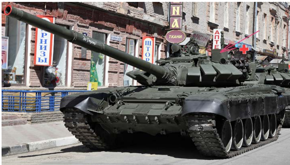
Малюнок 1.2.5 – Т-72Б3. Червоною стрілкою показана відмінність від інших Т-72, це тепловізор «Сосна-У», виробництвом Республіки Білорусь
