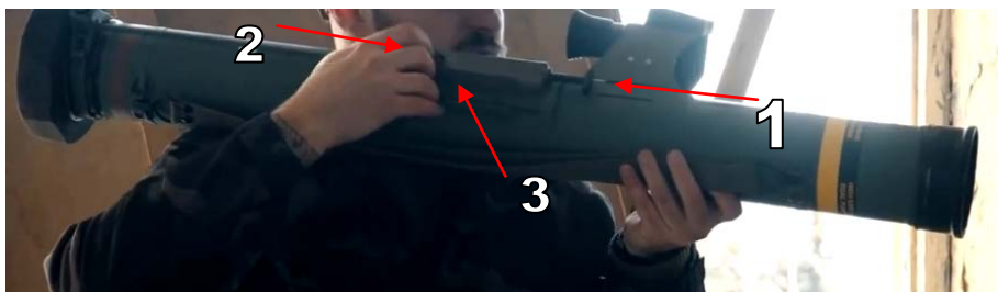
Малюнок 3.10.5 – 1. Ричаг зведення; 2. Запобіжник; 3. Кнопка пострілу
