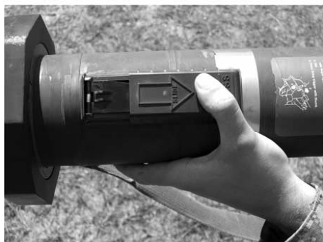
Малюнок 3.6.6 – Розкриття кришок цілика та мушки. Зліва – мушка, справа – цілик. Стрілками показано напрямок руху
