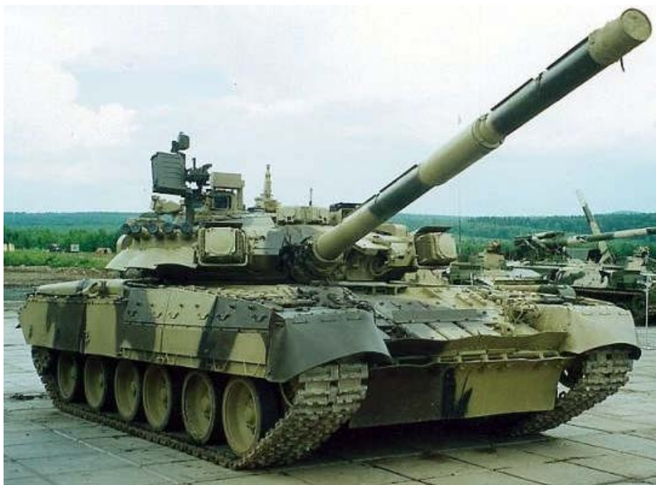
Малюнок 1.6.2 – Т-80УА. Справа-зліва від гармати добре видно блоки КОЕП «Штора-1»
