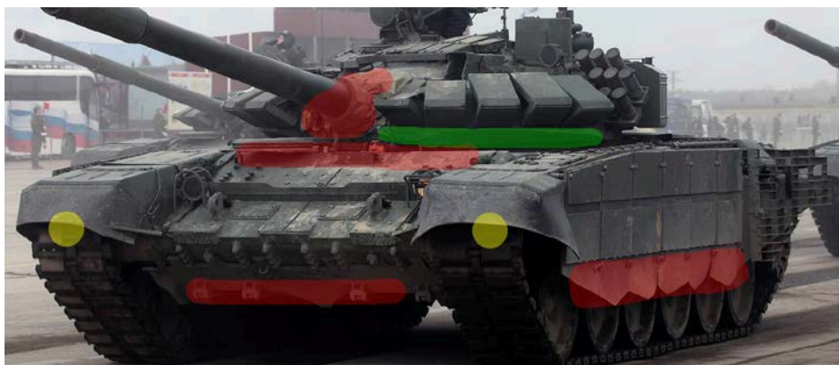
Малюнок 3.1.37 – Ураження Т-72Б3М та Т-80БВМ від гранат нетандемної дії, збоку та спереду. Справа та зліва від триплекса м/в у Т-72 ДЗ відсутній
