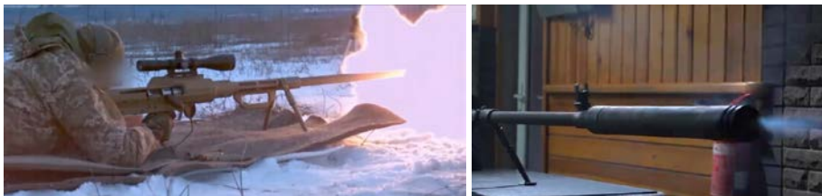
Малюнок 5.1.3 – Вогняне полум'я з дульним гальмом (зліва), та з глушиником
