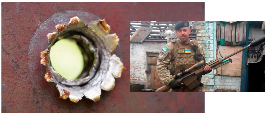
Малюнок 5.2.12 – Результат роботи патрона .50 BMG по бронепластині завтовшки 12 мм на відстані 400 м з гвинтівки PGW LRT-3
