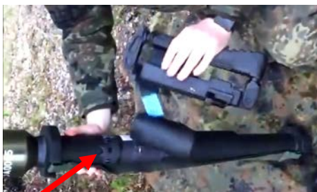
Малюнок 3.7.3 – Приєднання блоку управління вогнем. Червоною стрілкою показано паз для з'єднання
