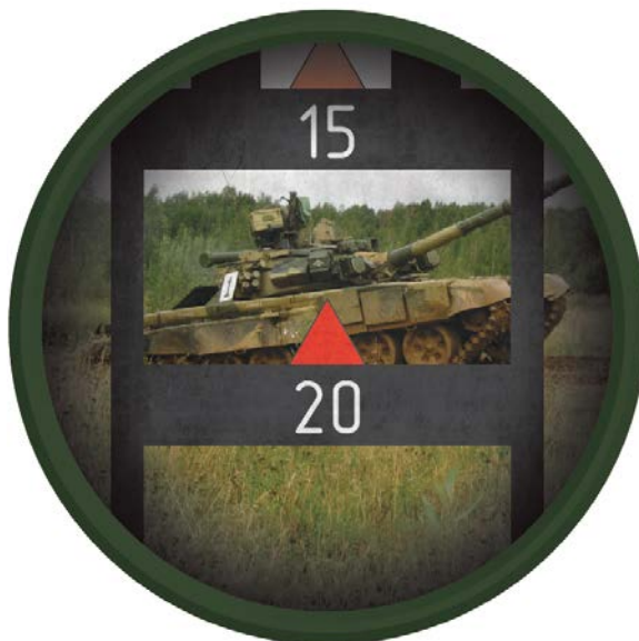
Малюнок 3.2.5 – Видимість в приціл РПГ-18 зразка 1975 року. Відстань до танка Т-90 складає 200 м
