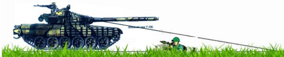
Малюнок 2.1.1 – Мертва зона для зброї танків Т-72, Т-80, Т-90 спереду – 20 м
