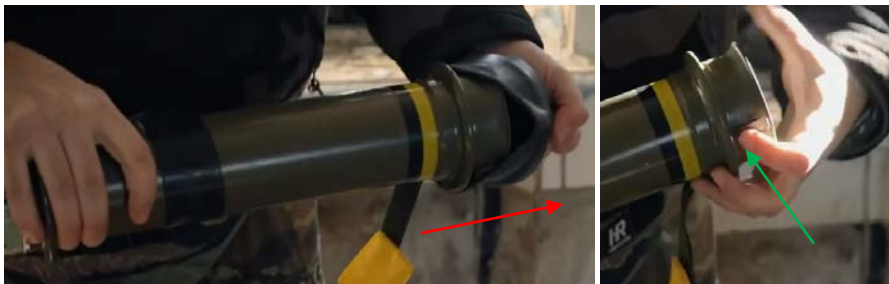
Малюнок 3.9.2 – Зняття гумової кришки (зліва), червона стрілка – напрям руху; Кнопка мушки (справа), зелена стрілка напрям руху натискання
