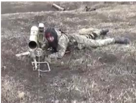
Малюнок 6.1.9 – Правильна позиція оператора перед стрільбою. При високо піднятих ногах станіни стрільба ведеться з коліна, але також під кутом 90^{\circ} . Також добре видно дріт керування ракетою
