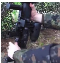
Малюнок 3.7.5 – Розкриття ручки зі спусковим гачком
