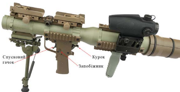
Малюнок 3.1.15 – Розташування запобіжника, курка та спускового гачка в PSRL-1
