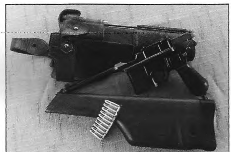
Маузер К96 – улюблена вогнепальна зброя Батька Махна. Кобура пістолета могла за бажанням використовуватися як приклад.
