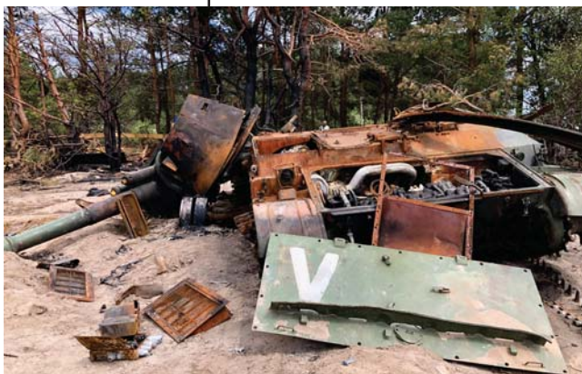
Рис. 23, 24. Кришка моторно-трансмійного відділення від самохідної гаубиці «Акація» з літерою «V» (Фото авторів)
