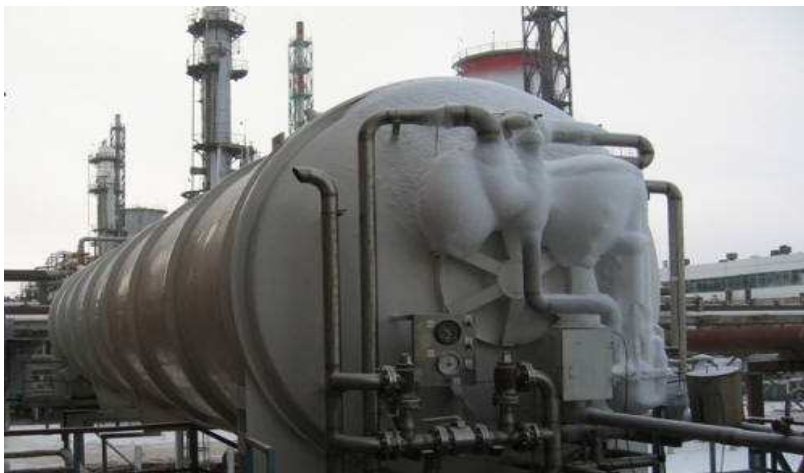
Зріджувач гелію (детандер) потужністю 700 л / год створений в НВО "Геліймаш"- Оренбурзький газопереробний завод.
