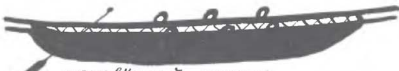
дерев'яний каркас, обтягнений шкірою моржа
