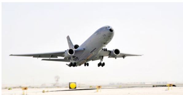
Рис. 13.6. KC-10A Extender. Літак KC-10A є повітряним заправником; якщо його обладнати спеціальними ношами для пацієнтів, він може бути використаний для аеромедичної евакуації.
