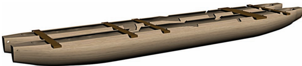
Рис. 12. 3D-модель з'єднання моноксилів між собою для сплаву
