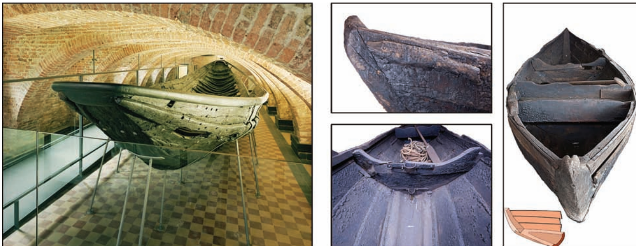
Рис. 10. Утрехтський набійний човен у музеї (Утрехтський Центральний музей, Нідерланди), фото та прорисовка «ростокського човна» XIX ст. (м. Штральзунд, ФРН), виготовленого на основі моносила
