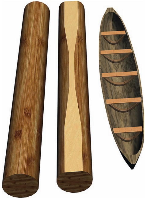
Рис. 7. Етапи виготовлення розпареного човна з розведеними бортами
