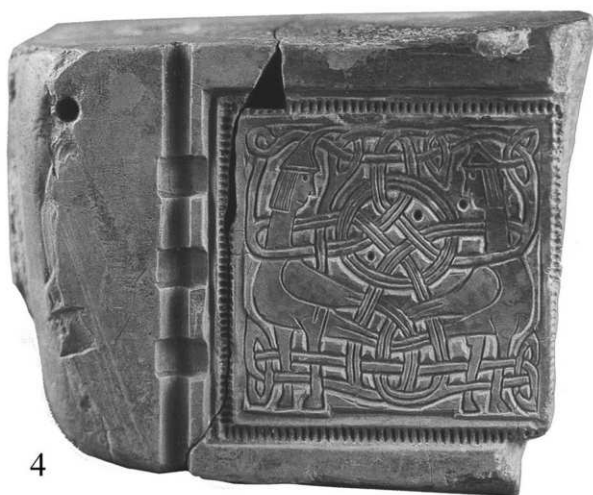
Рис. 266. Литейные формы. XII–XIII вв. Сланец. Киев. НМИУ: 1 – для отливки колта; 2 – энколпиона, В 1904/28110, В 2153/28109; 3 – звездчатого колта, № в 11/2883; 4 – пластинчатого браслета, № в 4553/114
